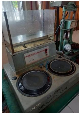
Gambar 2.1 Mesin Amplas Putar
