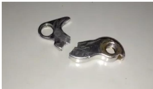
Gambar 2.4 Rear Derailleur Hanger patah
