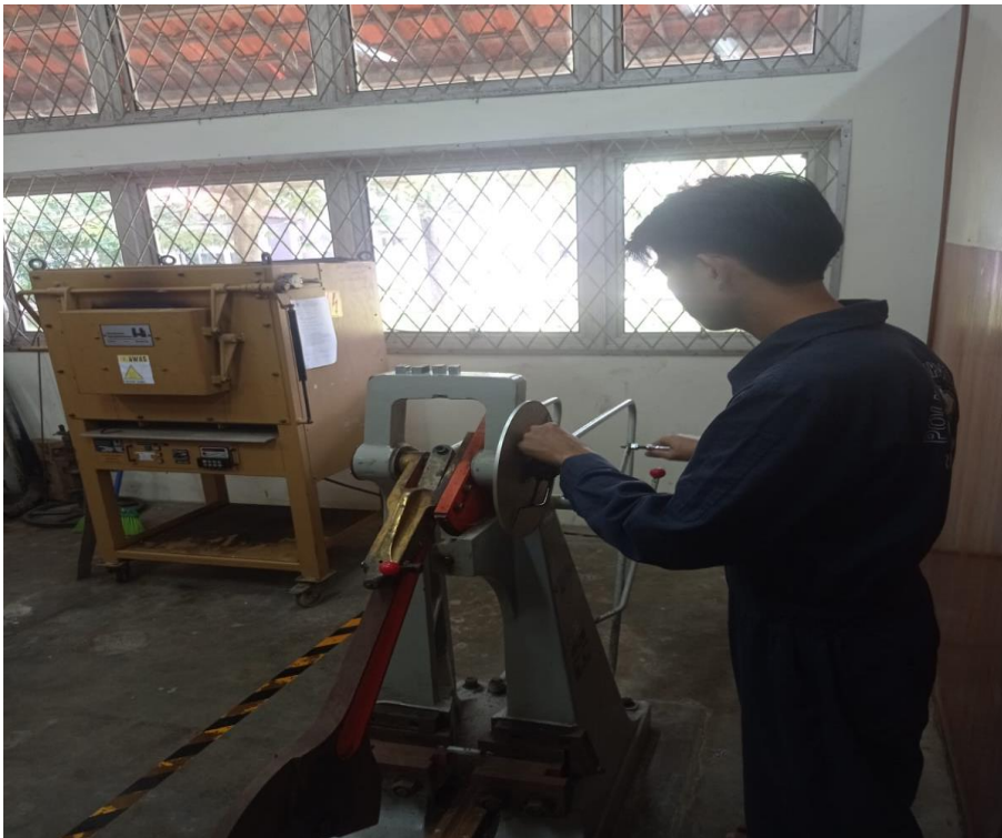
Proses Pengujian Impak
