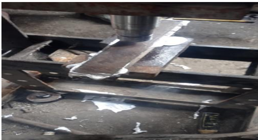
Proses pencetakan dan penekanan Spesimen
