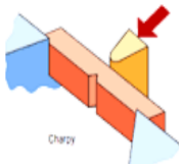
Gambar 2.10 Uji impak dengan metode Charpy (Sugiantoro, 2019)
