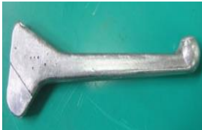
Gambar 2.1 Produk tuas rem sepeda motor berbahan aluminium (Riley, 2016)
