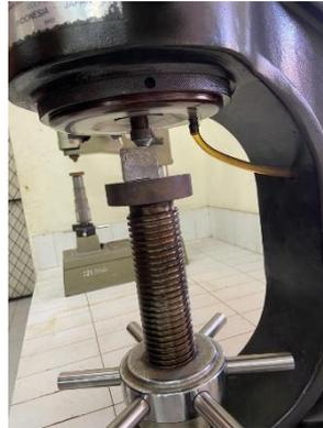
Gambar 2. 2 Pengujian *Brinell*
