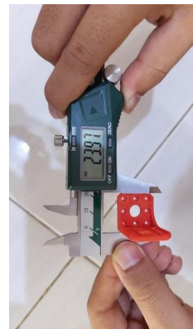
14. Proses pengukuran panjang, lebar, dan tinggi spesimen 5 mesin 3D Printing Core XY
