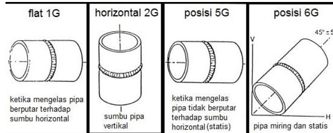
Gambar 2.27 Posisi Pengelasan pada Sambungan Pipa (Achmadi, 2023)
