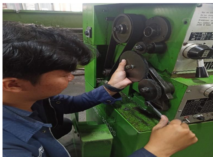
Proses Pemasangan Roda Gigi
