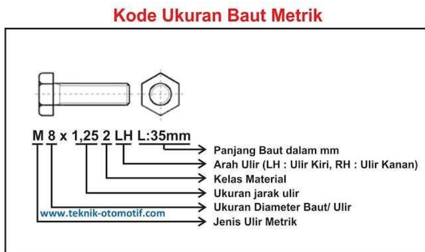
Gambar 2.5 Kode ukuran baut metrik (Roby Pranata, 2023)
