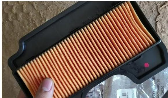
*Gambar 2.6 Filter udara Jupiter Z 115 cc*
