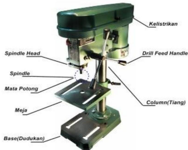
Gambar 2. 18 Bagian-bagian Bor Meja (tekniktempur.blogspot.com, 2018)
