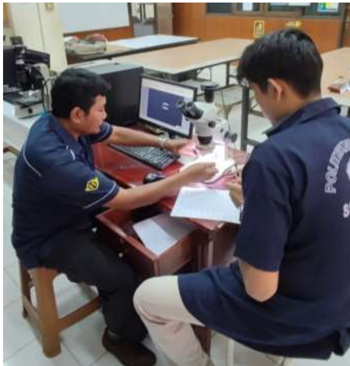
Proses penentuan nilai d_1 dan d_2 pada spesimen uji kekerasan vickers
