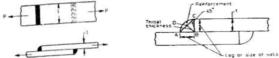
Gambar 2.7: Sambungan las *tipe lap joint*
