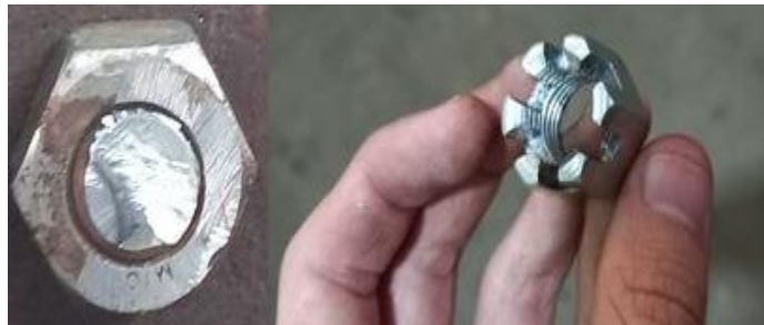
Gambar 2.12 Baut dan Mur serta Baut Pengencang Batu Gerinda
