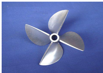
Gambar 2.4 Propeller Perahu Motor berbahan Aluminium
