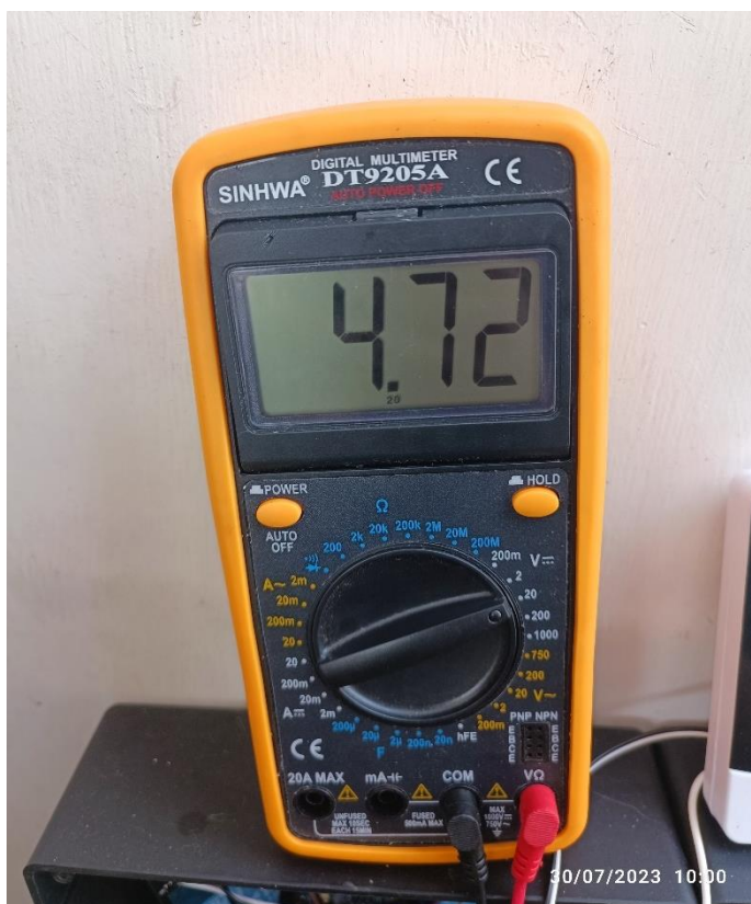
Pengukuran Tegangan Pada Sensor DHT 22
