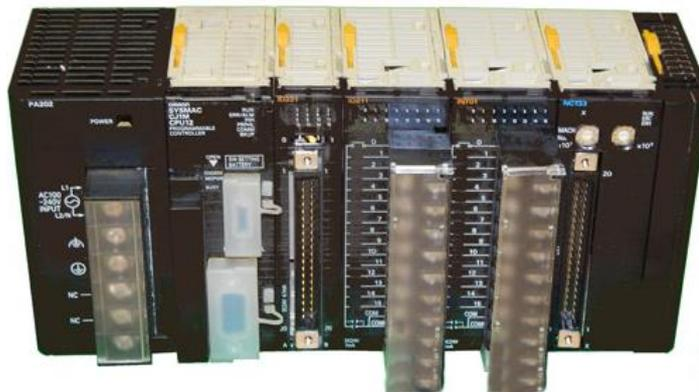
Gambar 2.5 PLC *Modular* dari Omron
