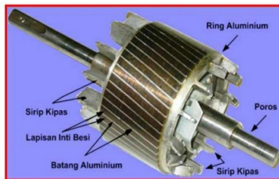
Gambar 2. 4 Rotor Sangkar
