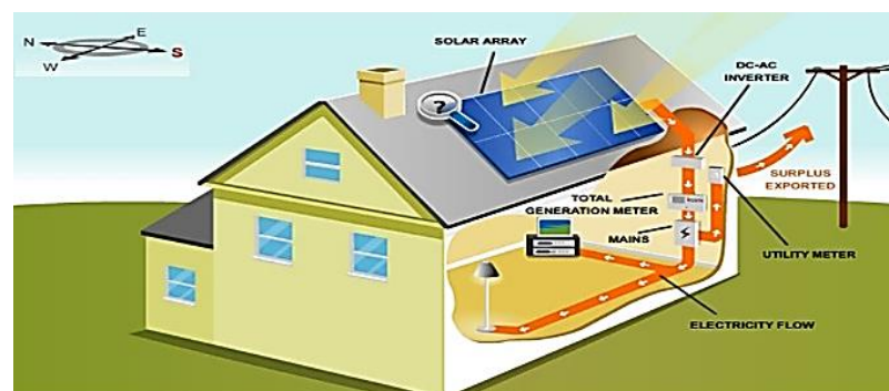
Gambar 2.2 Penggunaan PLTS Pada Rumah Tangga
