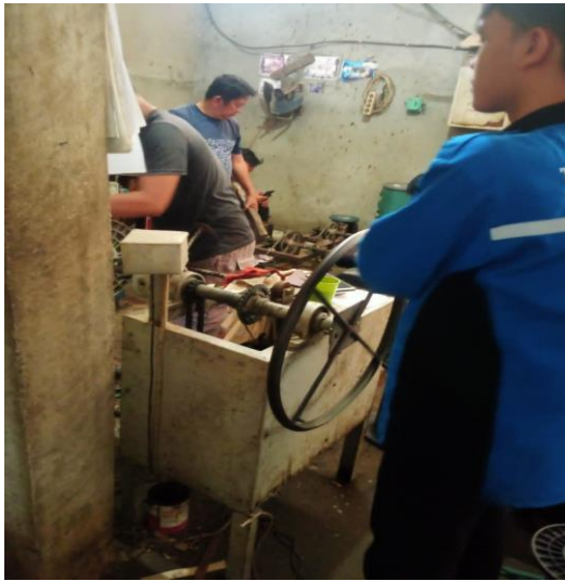
Gambar 1. Menggulung kabal trafo
