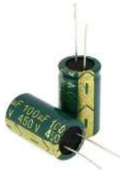
Gambar 2. 15 Capacitor 100 uf 450 V, 220 uf 50 V, 4700 uf 25 v
