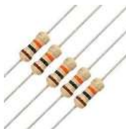
Gambar 2. 13 Jenis Resistor Yang Di Gunakan ( 10 ohm,0,1, 1k)
