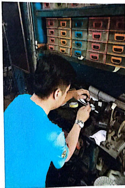
Penglilitan trafo di tempat Ko Ateng di Jalan Segaran
