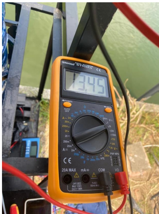
Gambar 2. Hasil Pengukuran Tegangan pada Multimeter
