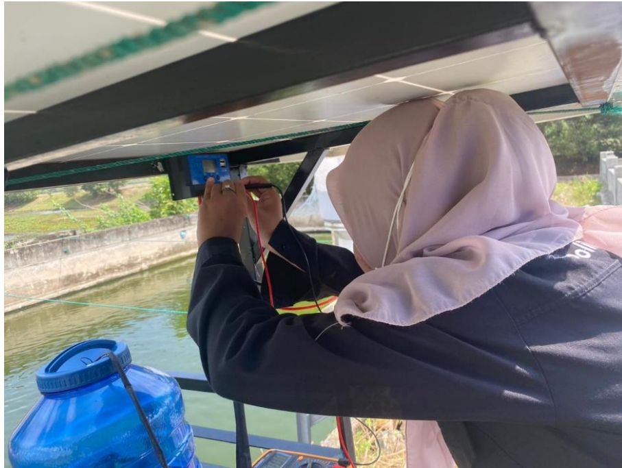
Gambar 4. Cara mengukur Tegangan atau arus pada SCC PWM
