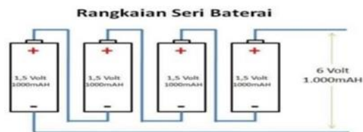
Gambar 2.20 Rangkaian Seri Baterai
