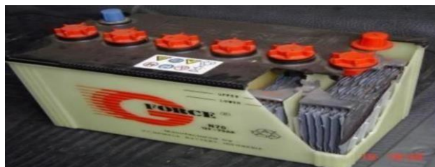
Gambar 2.16 konstruksi baterai stater
