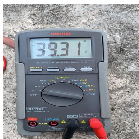
Tegangan DC Sebelum SCC
