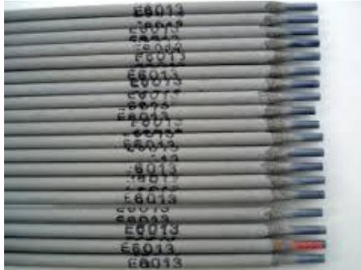
**Gambar 2.13 Elektroda Las Listrik**
