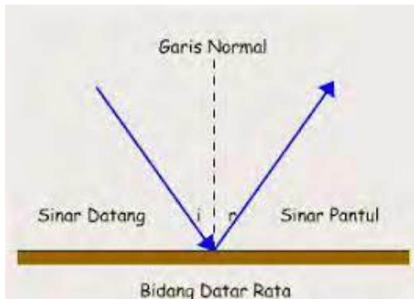
Gambar 2.11 Arah sinar datang membentuk sudut terhadap normal bidang panel surya
