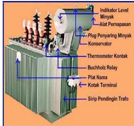
A. Bagian Luar Transformator
