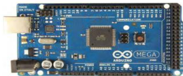
Gambar 2.1 Tampilan depan arduino mega 2560
