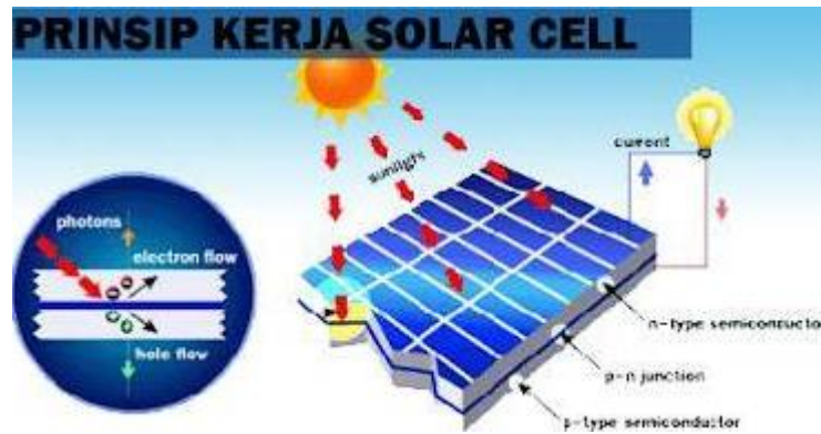
Gambar 2. 2 Prinsip Kerja Solar Cell (Sumber: Faisal Irsan Pasaribu, Muhammad Reza,2021)
