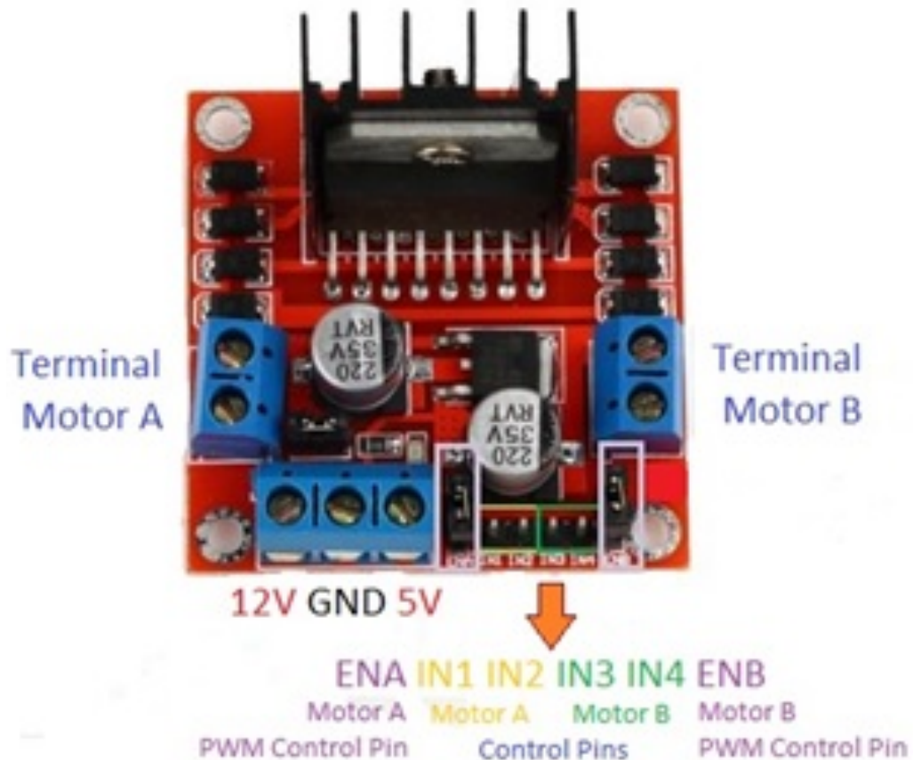
Gambar 2.12 Konfigurasi PIN L298N.
