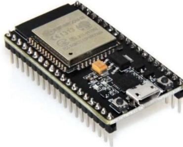
**Gambar 2.7** Mikrokontroler NodeMCU ESP32 <sup>[12]</sup>
