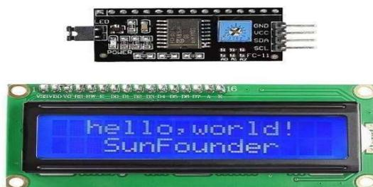
**Gambar 2.11** LCD 16 x 2 dan I2C <sup>[17]</sup>
