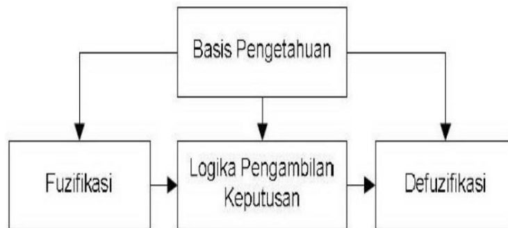
Gambar 2.11 Struktur dasar pengendali fuzzy
