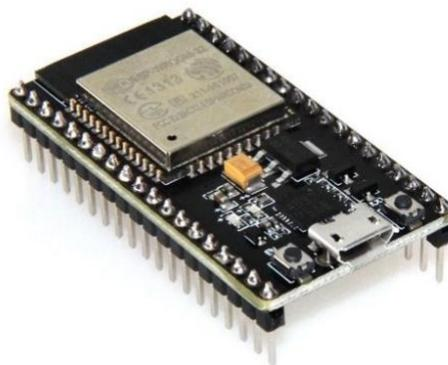
**Gambar 2.10** Mikrokontroler NodeMCU ESP32
