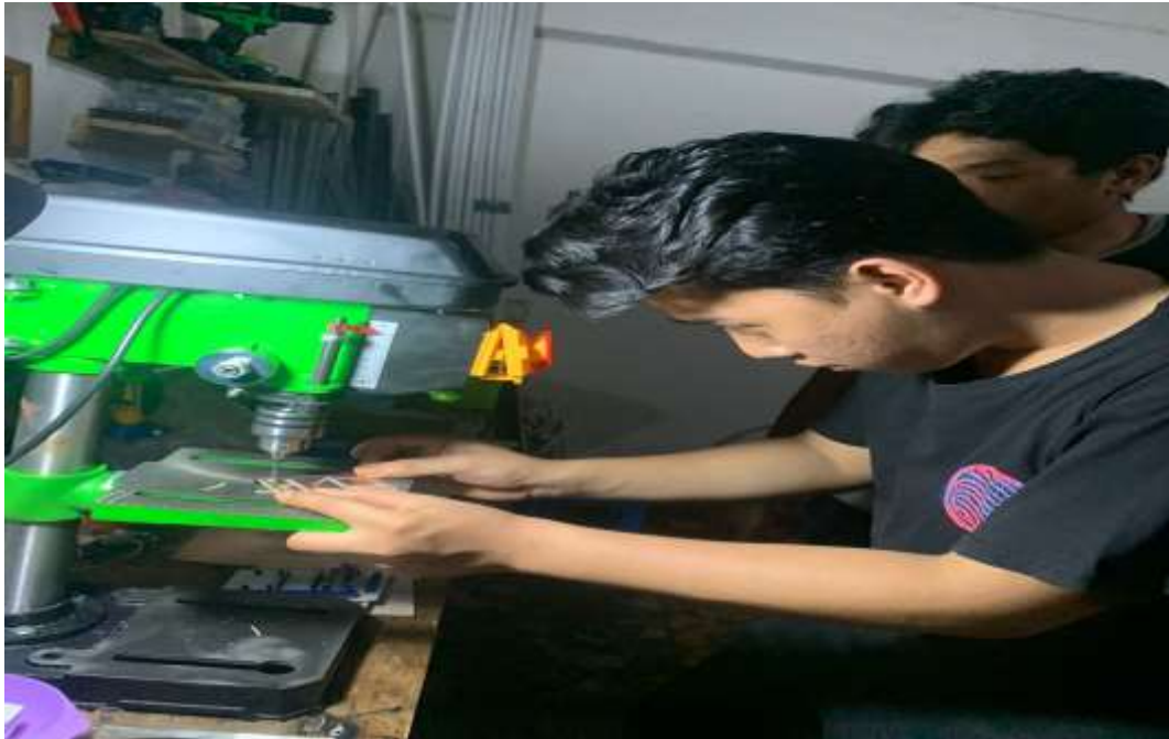
Keterangan : Proses Pengeboran PCB
