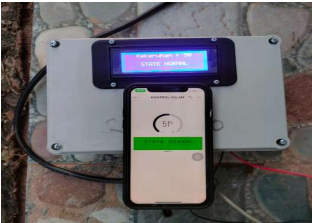
Keterangan : gambar box PBC dan aplikasi blynk server
