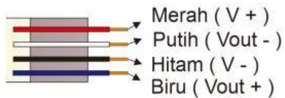
Gambar 2. 7 Keterangan Kabel Load cell
