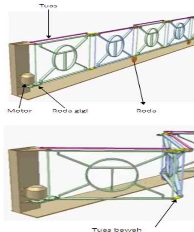
Gambar 2.8 Mekanisme penggerak pagar dengan sistem roda gigi.
