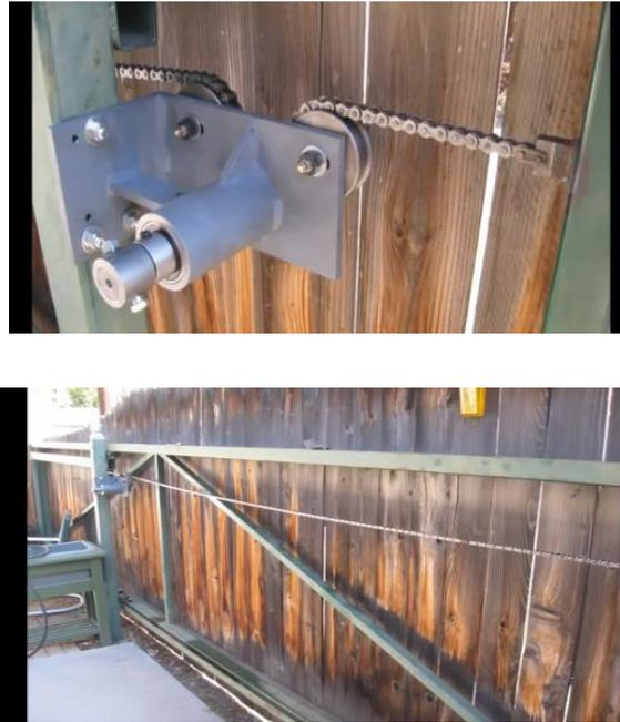
Gambar 2.9 Mekanisme penggerak pagar dengan sistem rantai
