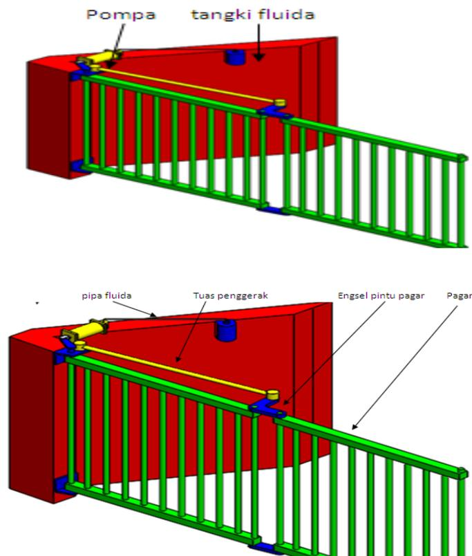
Gambar 2.7 Mekanisme penggerak pagar dengan sistem *hydraulics*
