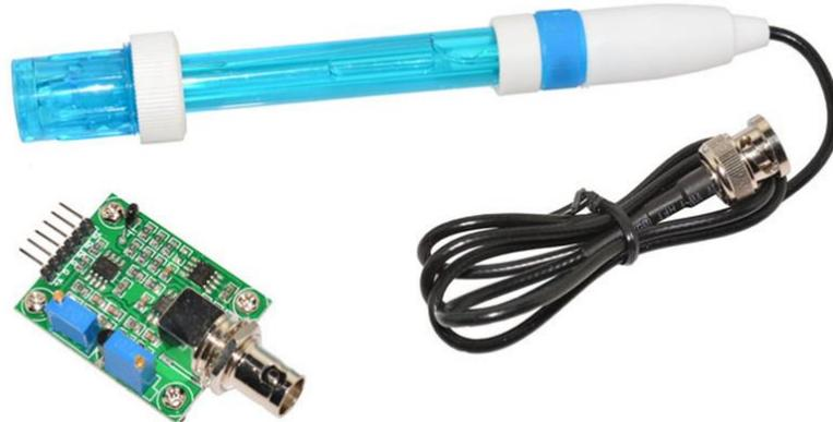
**Gambar 2.2** Modul pH sensor pH 4502C dan probe konector BNC E-201-C-9
