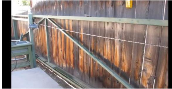
Gambar 2.9 Mekanisme penggerak pagar dengan sistem rantai
