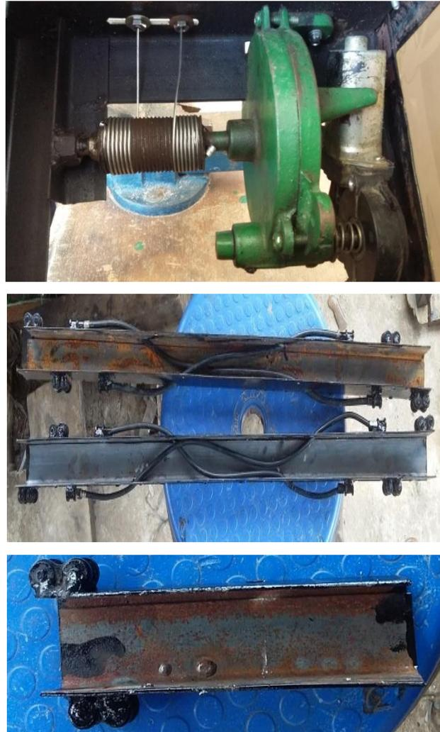
Gambar 2.10 mekanisme penggerak pintu pagar dengan sistem tali kawat baja.
