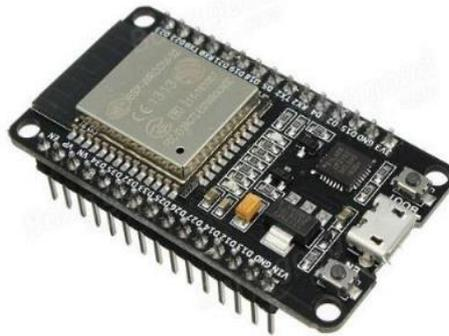
**Gambar 2. 7** Mikrokontroller ESP32
