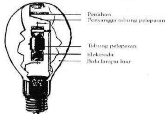
Gambar 2. 6 Konstruksi lampu metal halida
