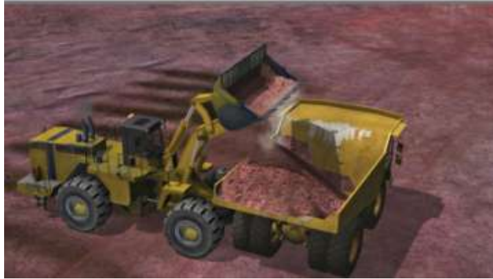
Gambar 2.5 Wheel Loader pada Posisi L Loading
