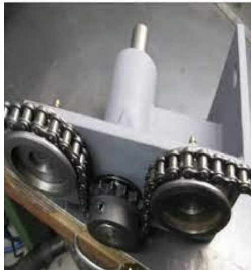
Gambar 2. 6 Mekanisme Penggerak Pintu Pagar Menggunakan Rantai (Sumber: http://bitly.ws/BQz5 )
