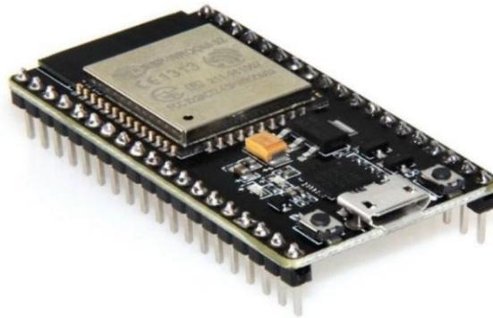
**Gambar 2.8** Mikrokontroler NodeMCU ESP32 <sup>[12]</sup>
