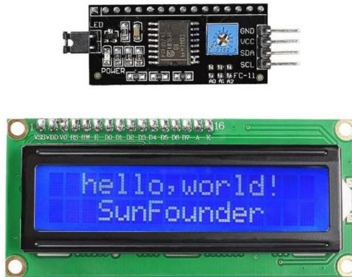
**Gambar 2.12** LCD 16 x 2 dan I2C <sup>[17]</sup>
