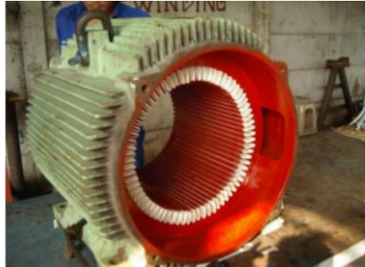
Gambar 2.12 Bentuk konstruksi stator pada generator sinkron
