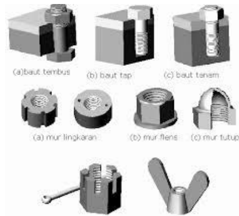
Gambar 2.15 Macam – macam mur dan baut
