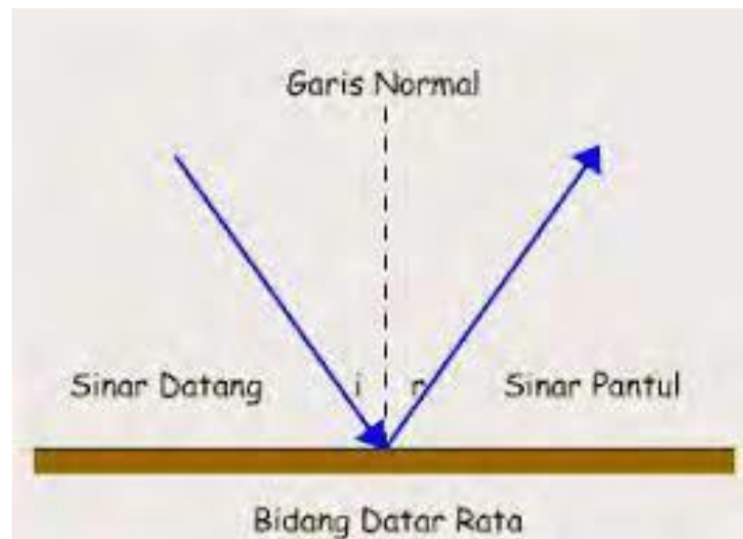
Gambar 2.5 Arah sinar datang membentuk sudut terhadap normal bidang panel surya
