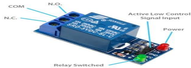
Gambar 2. 17 Skema Modul Relay Arduino
