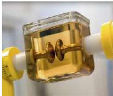
**Gambar 2.6 Minyak Isolasi Trafo Tenaga**
