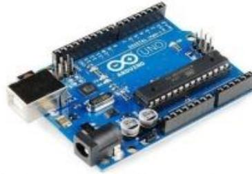
**Gambar 2.5. Arduino Uno ATmega328p**
