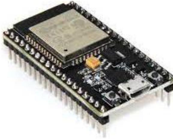
**Gambar 2.5** Mikrokontroler ESP32
